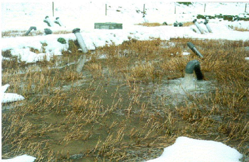
Photo 7 : La vitesse d'alimentation doit permettre l'immersion complète du filtre
